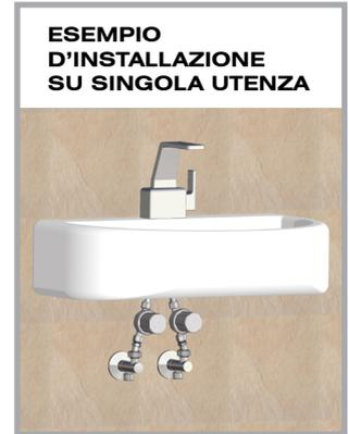
L'anticolpo d'ariete può essere installato in posizione verticale, orizzontale e capovolta.
